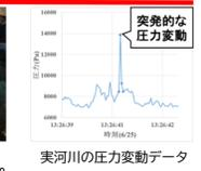
目的：突発的な圧力変動の原因を特定し、実河川での計測データから除去する
